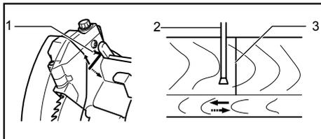
1. Закрутите, чтобы изменить диапазон смещения регулировочного винта
