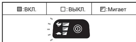
В случае перегрузки инструмента из-за скопления сорняков или прочего мусора инструмент выключается автоматически, начинают мигать все индикаторы скорости. В этом случае выключите инструмент и прекратите использование, повлекшее перегрузку инструмента. Затем включите инструмент для перезапуска.
